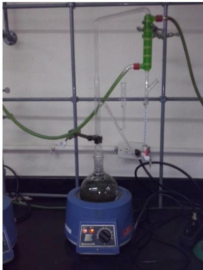
Extracción de aceite esencial por Neoclevenger
